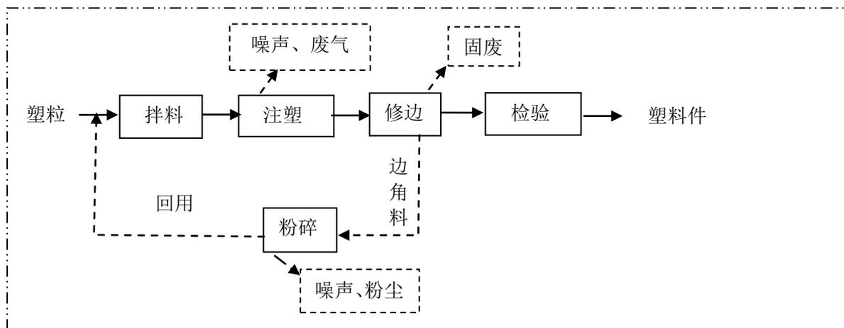
图 5-3 塑料件生产工艺流程和产污环节
