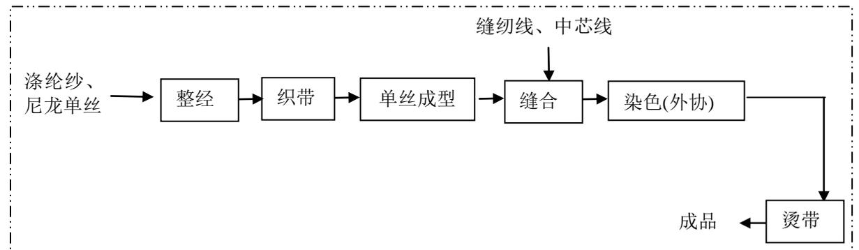
图 5-2 拉链生产流程和产污环节图
