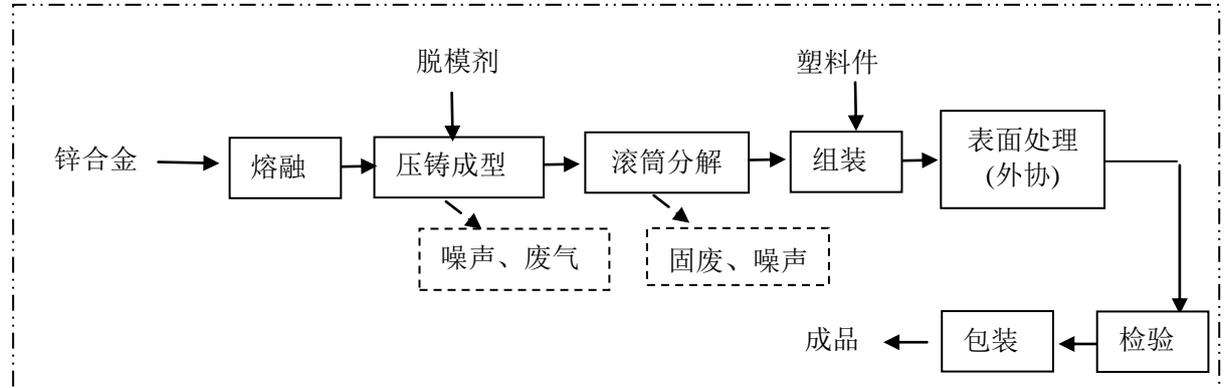
图 5-1 拉链头生产工艺流程和产污环节图
