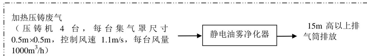
图 7-1 生产车间废气处理系统图
